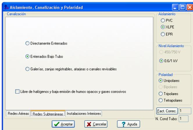
Una vez diseñada la red eléctrica, el programa **calcula automáticamente** todas las secciones a calentamiento y caída de tensión y la protección a sobrecargas y cortocircuitos, aplicando para ello **cálculo matricial, algoritmos de optimización**, etc.
